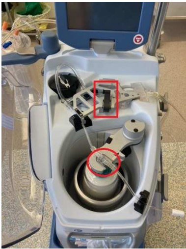
Verrouiller le bocal et la grille Faire tourner le bocal à la main pour vérifier sa position
