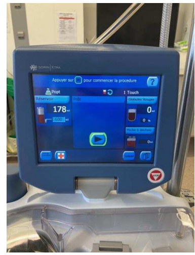
Allumer à l'arrière, valider la mise en place de la tubulure automatique autour du galet
